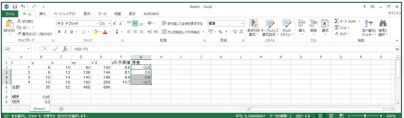
残差の2乗を求めるために、H2 に  $=G2^2$  とタイプする。H2 をコピーして、H3 から H5 に貼り付ける。下の結果が得られる。
